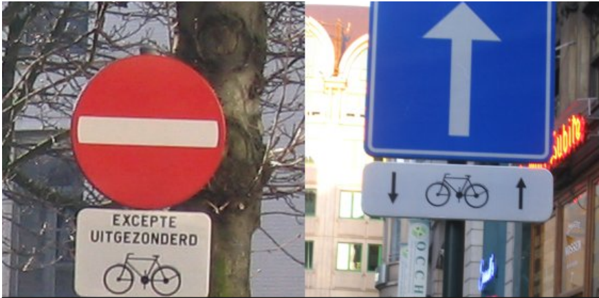
Bruselas (Bélgica). Señales verticales en ambos extremos de un sentido reservado.
